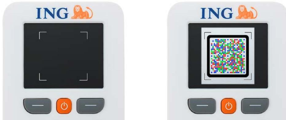
Der Scan-Modus bleibt für 15 Sekunden aktiv. Scannen Sie in dieser Zeit nicht, erscheint im Display die Info, dass keine Grafik erkannt wurde – und das Gerät fordert Sie auf, die passende Grafik zu scannen. Sobald die Grafik im Rahmen liegt, erkennt der photoTAN-Generator sie und scannt automatisch.
